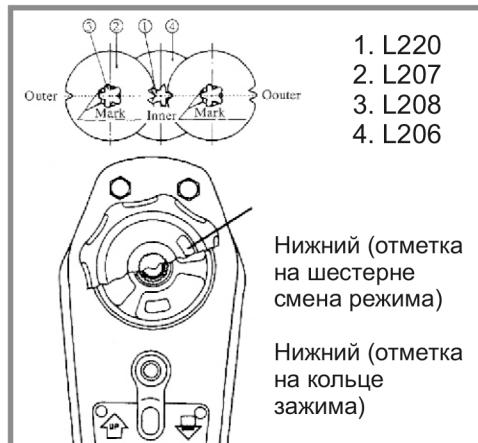
Зубья по осевой линии двух марок на шестеренчатом шлифе L207 должны быть расположены поперек детали L220 во внутренней / внешней компоновке модели 0,75 т, поблизости от внутренней / внешней компоновки для модели 3 т, на свободной позиции для модели 1,5 т.
